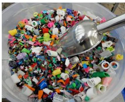
ペンの部材には、それぞれの特徴を活かして様々なプラスチックが使われています。プラスチックは、比重の違いで、水に浮くもの、沈むものに分かれます。定規へ作り変えることのできる「ポリプロピレン」、「ポリエチレン」というプラスチックは、水に浮くプラスチックです。粉碎したペンの部材を水の中に入れ、浮いているものだけを選別することで、回収したペンから定規の材料を取り出すことができました。
