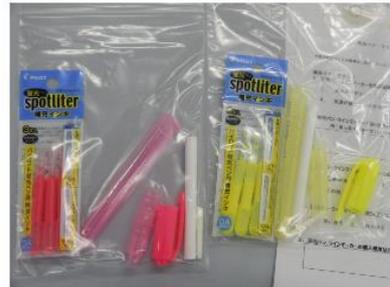
まず、ペン先にチップをはめ、胴体の中綿を入れます。中綿に少しずつインキを吸収させ、胴体とペン先部分をしっかり止めたら完成です。中には、ピンクとイエローのインキを両方吸収させたり、ピンクの胴体にイエローのインキを吸収させたり、ピンクの胴体にイエローのキャップをはめたり・・・と、生徒それぞれにマーカーペンを組み立てていました。
